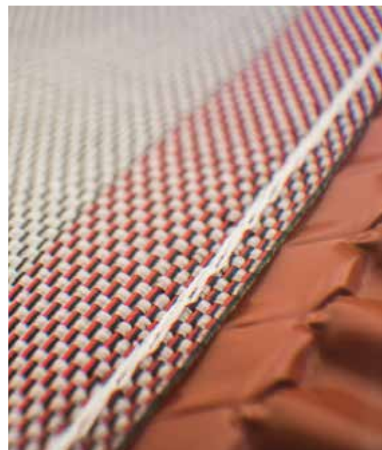
Im Bild die Sicherheitsnaht und das zentrale Gewebe.
