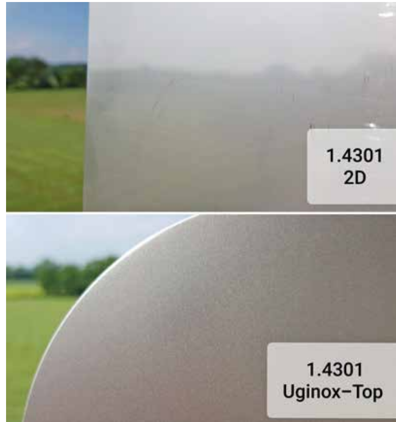
Walzblanke Oberfläche versus matt mustergewalzte Struktur.
