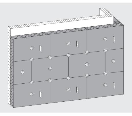
Durchgehend wasserabweisende Steinwolle-Dämmplatte für die außenseitige Dämmung von vorgehängten hinterlüfteten Fassaden. Schnell und einfach zu verlegen. Auch geeignet als Kerndämmung für zweischaliges Mauerwerk.
