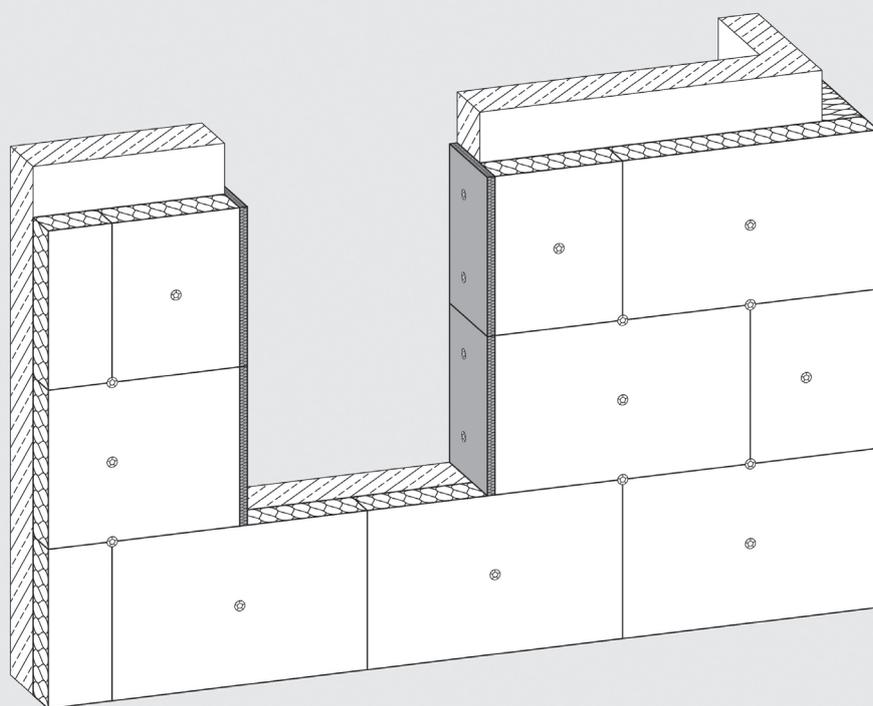
Durchgehend wasserabweisende Steinwolle-Dämmplatte mit einseitiger schwarzer Vlieskaschierung für die außenseitige Dämmung von Fenster- und Türleibungen in vorgehängten hinterlüfteten Fassaden.
