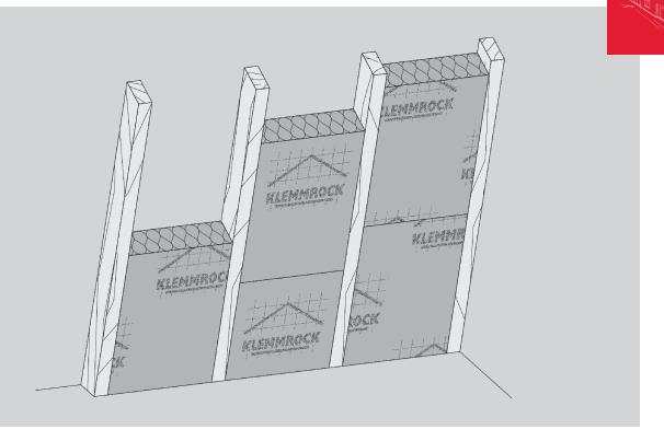
Nichtbrennbare Steinwolle als hoch komprimierte Rolle für die auf Maß geschnittene Dämmung zwischen den Sparren.
