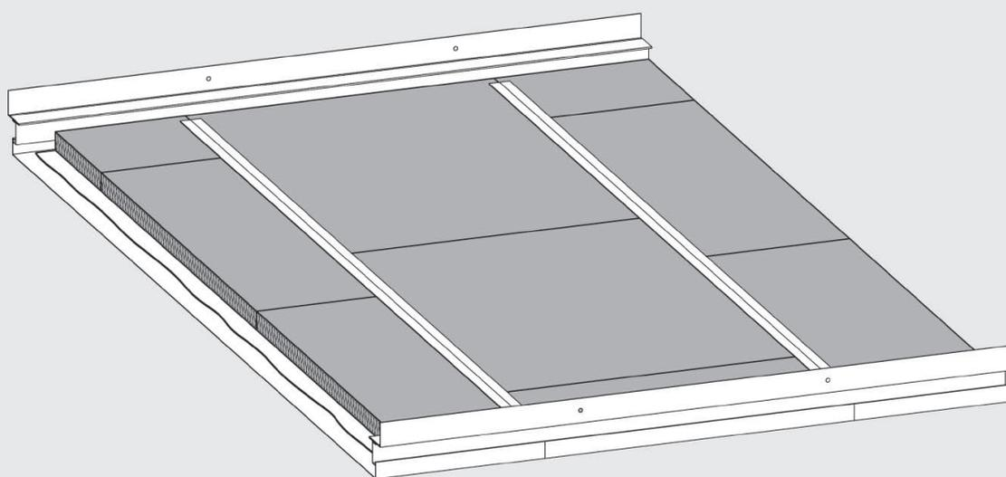
Formstabile Steinwolle-Dämmplatte als schallabsorbierende Auflage auf abgehängten, gelochten oder geschlitzten Akustikdecken sowie Wandbekleidungen mit Trennvlies.
