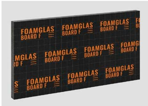
FOAMGLAS® BOARD F bestehen aus verklebten FOAMGLAS® F Platten, die oberseitig mit einer Verbund-Kaschierung aus Spezialglasvlies und PE-Folie und unterseitig mit Glasvlies versehen sind. Die oberseitige Kaschierung ist gelb, auf der Unterseite befindet sich ein weißes Vlies.
